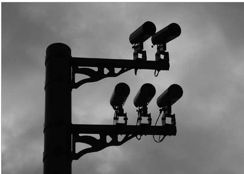
Foto 1. El reconocimiento automático de matrículas se efectúa con cámaras digitales CCTV.
